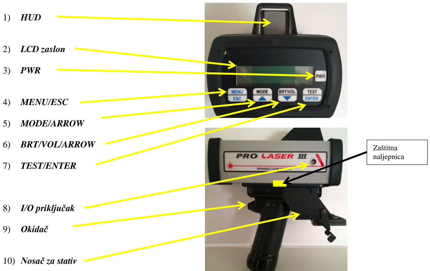
Slika 6. ProLaser III – Dijelovi i funkcionali
